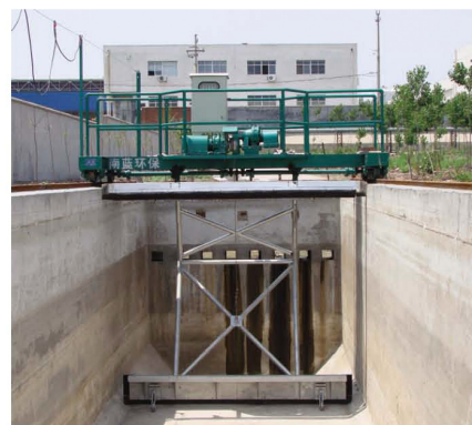
TGN 型行车式抬耙刮泥(撇渣)机 主要技术参数: 池宽: 4-14m
