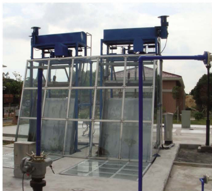
GSGS 型钢绳牵引式格栅除污机 主要技术参数 栅渠宽度 \leq 3\text{m} 栅渠深度: \leq 12\text{m} 设备宽度: 300-3000mm 格栅安装角度: 75^\circ-90^\circ
