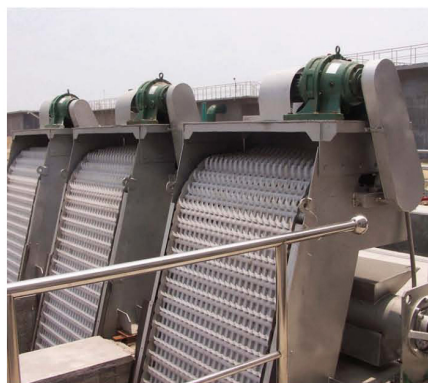
GSHZ 型回转式格栅除污机 主要技术参数: 渠深: 1-10m 栅隙: 3-50mm 设备宽度: 300-3000mm
