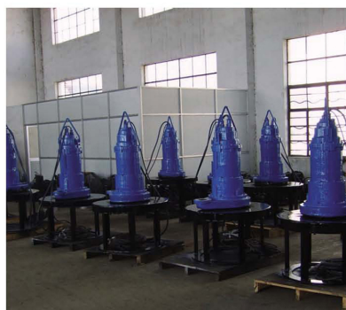
QXB 型潜水离心式曝气机 主要技术参数: 电机功率: 1-22\text{kW}
