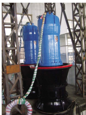
潜水轴流泵 主要技术参数 Q=360-18000\text{m}^3/\text{h} H=0.5-18\text{m} P=7.5-400\text{kW} D=350-1400\text{mm}
