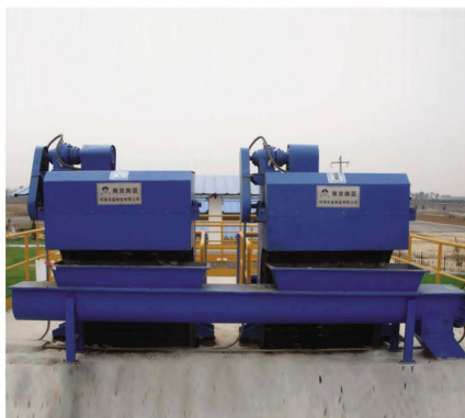
WLS 系列无轴螺旋式输送机 主要技术参数: 螺旋转速: 20r/min 螺旋直径: 200-420mm 输送量: 1.0-12.8m³/h
