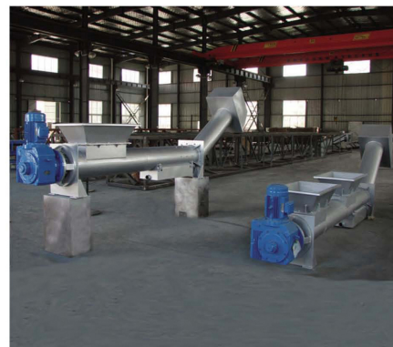
LYZ 型螺旋压榨机 主要技术参数: 功率: 1.1-5.5kW 螺旋管直径: 219-402mm 螺旋圈数: 6、9、11 圈
